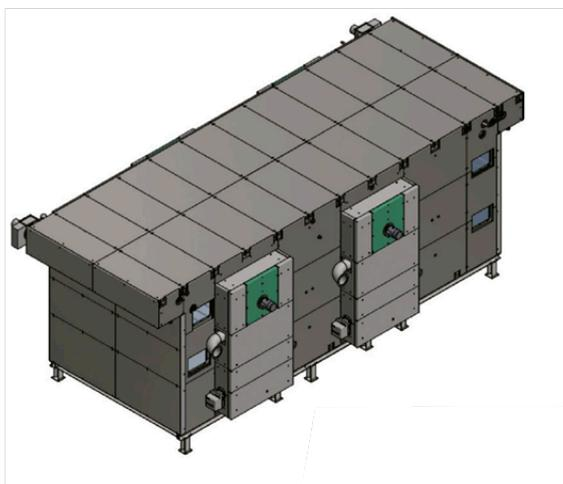
El campo de vapor es el cuerpo principal del vaporizador, en el mismo se encuentran los siguientes componentes fundamentales para el buen funcionamiento del tratamiento de fijación del color estampado previamente en el tejido:
