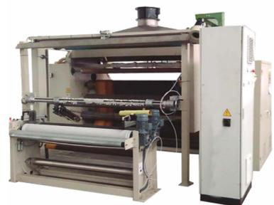
El tejido a la salida se enrolla para su comercialización, en rollos del diámetro necesario. Mientras que el papel se enrolla en barras neumáticas unicadas en la parte superior de la máquina.
