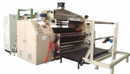
La entrada de tejido está formada por un centrador de tejido que es el encargado que el tejido entre en la máquina propiamente dicha, completamente centrado para que cuando se produzca la transferencia de calor el dibujo quede posicionado en el centro del tejido.
